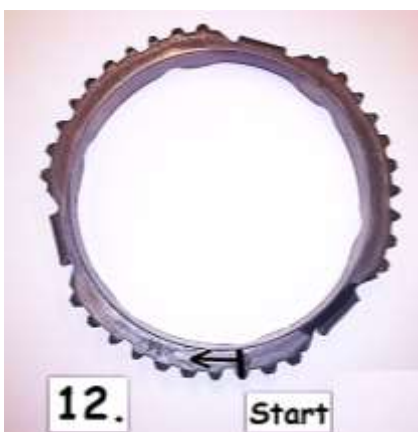
Rys. 3. Badany pierścień zębata o numerze 12. Zaznaczono punkt startowy pomiaru WRPM
