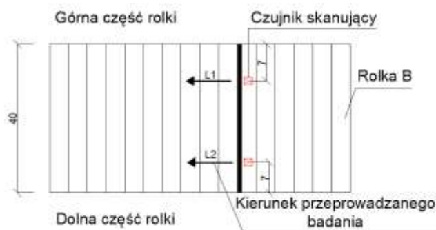
Rys. 5. Schemat pomiaru koła zębatego wraz z zaznaczonymi drogami pomiarowymi L1 i L2
