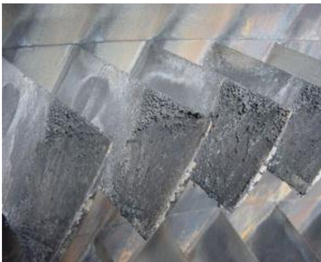
Rys. 6. Spieczony nalot ciał obcych (piasek, kurz) na łopatkach ostatniego stopnia kompresora [20].
