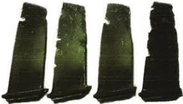
Rys. 5. Łopatki kompresora uszkodzone mechanicznie w wyniku ich kontaktu z ciałami obcymi [14].
