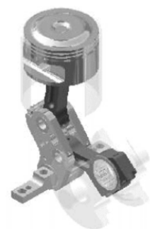
Rys. 5. Układ korbowy jednego tłoka silnika pneumatycznego
