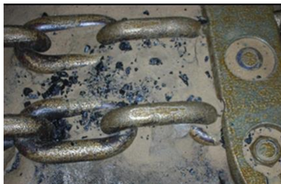
Rys. 1. Przykładowy widok zanieczyszczonego piaskiem i wodą fragmentu przenośnika zgrzeblowego w strefie wysypu
