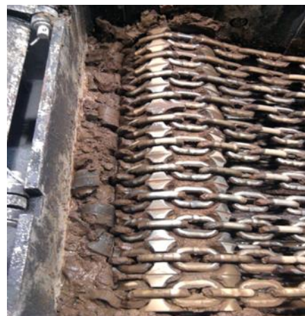
Rys. 4. Widok stanowiska zużyciowego wypełnionego mieszaniną ścierną złożoną z piasku kwarcowego i wody w końcowej fazie traktacji badań zużycia tribokorozyjnego.
