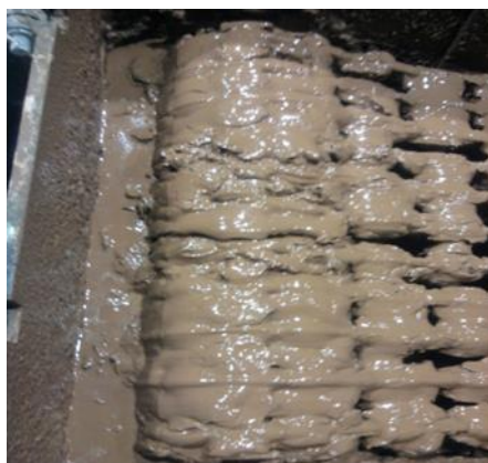
Rys. 3. Widok stanowiska zużyciowego wypełnionego mieszaniną ścierną złożoną z piasku kwarcowego i wody w początkowej fazie traktacji badań zużycia tribokorozyjnego.
