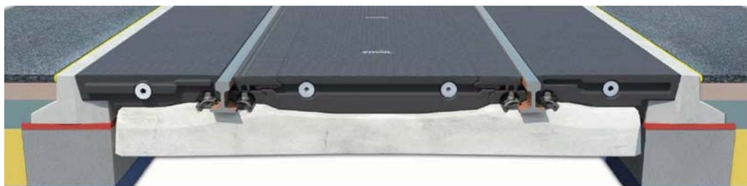
Rys. 6. Rysunek schematyczny systemu veloSTRAIL [8]
