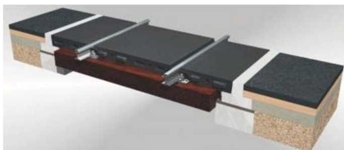
Rys. 8. Rysunek schematyczny nawierzchni ELASTrack [12]
