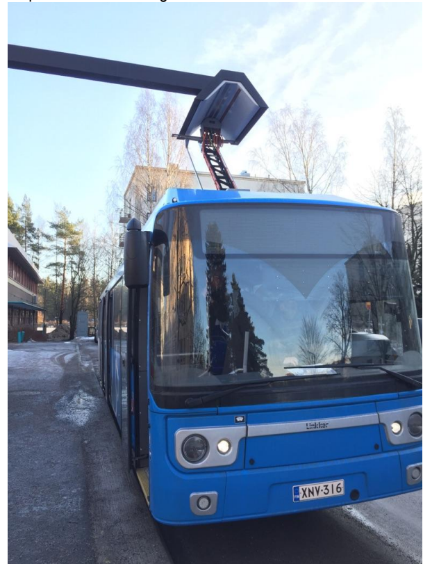
Rys. 3.2. Ładowanie autobusów elektrycznych Linkker w systemie opportunity charging odbywa się podczas wsiadania pasażerów na przystankach [ 3 ]
