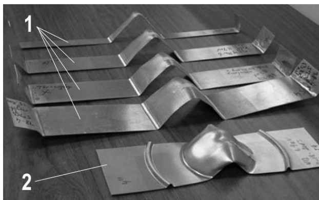
Rys. 3. Kształty próbek po wyznaczeniu WOG w matrycy z wycięciem w kształcie litery V (1) oraz w matrycy z otworem przelotowym (2), opracowano na podstawie [12]
