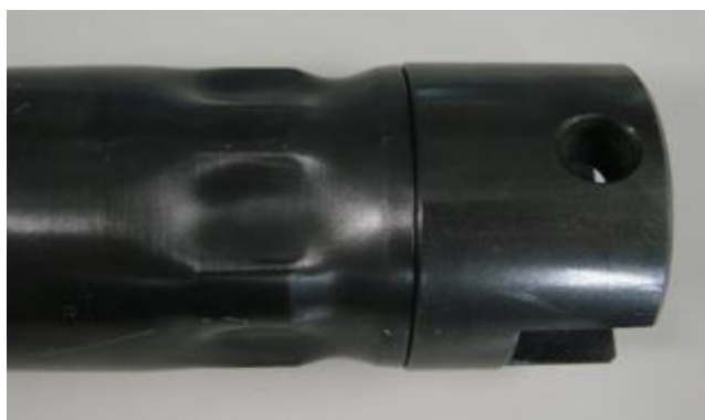
Rys. 3. Połączenie zaciskowe elementów wału napędowego [11]
