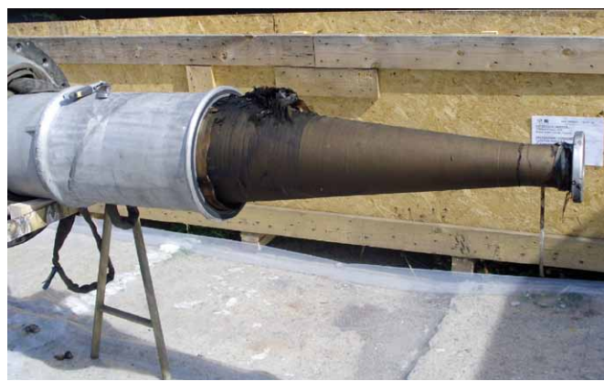
Rys. 4. Widok części stożkowej rdzenia (4) izolatora fazy B1 po awarii
